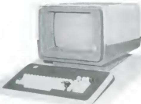
**Modello T MKIII:** Testata separata — video verde analfisso 24 righe 80 colonne con doppio set stampante / carta — oltre 70K di memoria centrale — dati flessibili da 5 ed 8 pollici con capacità di 50 150 350 512 e 1024K / disco — disco fisso da 10M — dati analogici da 5-5 10-10 16-16 e 16-80 milioni di caratteri — fino ad otto utenti — tutti i linguaggi più diffusi — compatibile IBM e CP/M — pochi applicativi per aziende professionali alberghi ingegneri laboratori di analisi ecc.
